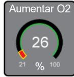
Si el usuario pulsa y mantiene pulsado el control de parámetro de aumento O2, un nuevo control aparece sobre el panel de mensajes. El usuario pulsa este control y confirma la acción, y el procedimiento se cancela.
