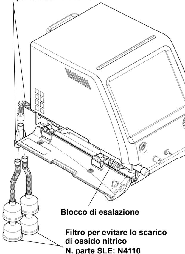
**Avviso:** dopo aver usato il ventilatore con un dispositivo per terapia con ossido nitrico, risciacquare il blocco di esalazione con acqua prima delle operazioni di pulizia, disinfezione o sterilizzazione in autoclave. Ciò serve a rimuovere eventuali depositi di ossido nitrico, che, durante la sterilizzazione in autoclave con vapore, potrebbero reagire con l'acqua portando alla formazione di acido nitroso o di acido nitrico.
