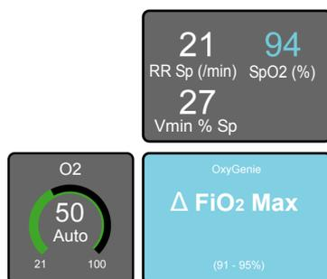
Il monitoraggio SpO<sub>2</sub> si ottiene mediante i sensori Masimo SET. Gli allarmi SpO<sub>2</sub> alti e bassi sono automaticamente impostati all'1% sopra il limite superiore dell'intervallo stabilito e l'1% sotto il limite inferiore dell'intervallo stabilito. Questi limiti sono regolabili dall'utente.
