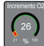
Se l'utente tiene premuto il controllo del parametro Aumento O<sub>2</sub> compare un nuovo controllo sul pannello del messaggio. L'utente preme questo controllo e conferma che l'azione della procedura viene annullata.
