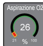
Quando l'utente riconnette il paziente prima della fine della finestra di aspirazione di 2 minuti, il ventilatore avvia un nuovo conto alla rovescia di 2 minuti, alla % O<sub>2</sub> elevata. Viene mostrato il messaggio "Post aspirazione O<sub>2</sub> in corso".
