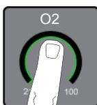
Viene visualizzato il messaggio "Aspirazione O<sub>2</sub> in standby" oltre il controllo del parametro O<sub>2</sub> (il controllo è rinominato "aspirazione O<sub>2</sub>"). Il più/meno e il pulsante di conferma diventano attivi.
