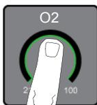
Viene visualizzato il messaggio "Incremento O<sub>2</sub> in standby" oltre il controllo del parametro O<sub>2</sub> (il controllo è rinominato "Incremento O<sub>2</sub>"). Il più/meno e il pulsante di conferma diventano attivi.
