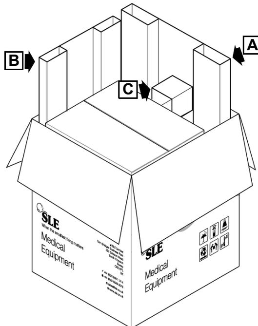
**Nota: il nastro dell'imballaggio (C) può essere sostituito dalla base del riscaldatore per umidificatore.**
