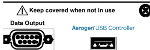
**Nota:** il controller USB Aerogen® può essere azionato solo da una porta USB su qualsiasi dispositivo medico elettrico approvato in base a IEC/EN 60601-1 o adattatore CA/CC del controller USB Aerogen.
