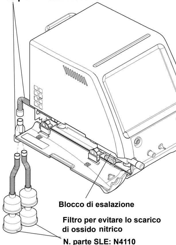
**Attenzione:** dopo aver usato il ventilatore con un dispositivo per terapia con ossido nitrico, risciacquare il blocco di esalazione con acqua prima delle operazioni di pulizia, disinfezione o sterilizzazione in autoclave. Ciò serve a rimuovere eventuali depositi di ossido nitrico, che, durante la sterilizzazione in autoclave con vapore, potrebbero reagire con l'acqua portando alla formazione di acido nitroso o di acido nitrico.
