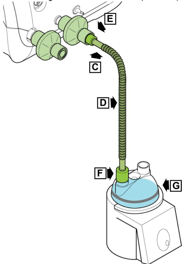
3 Collegare l'estremità libera (F) della linea di alimentazione del gas fresco (D) a una delle porte della camera di umidificazione (G).
