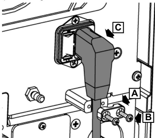
Fissare il cavo rimontando il morsetto (N) e utilizzando le due viti (O).
