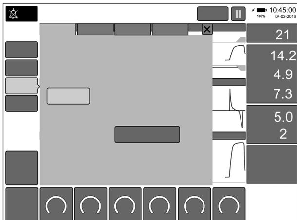
**Nota: quando il sensore di flusso è collegato, il pulsante di calibrazione del sensore di flusso è selezionato per impostazione predefinita. Quando si utilizza il ventilatore senza il sensore di flusso, solo la calibrazione O2 a un punto è selezionata per impostazione predefinita.**
