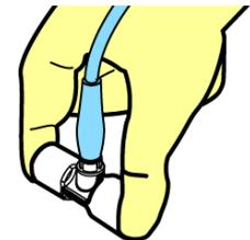
**Attenzione: per evitare la contaminazione del sensore di flusso, utilizzare i guanti quando si effettua la calibrazione.**
