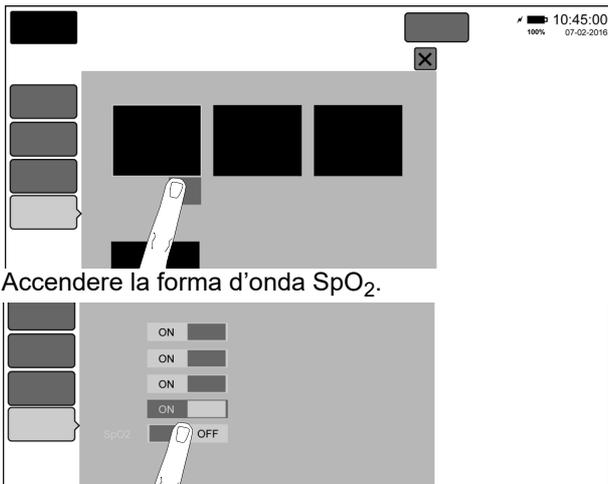
Si aggiungerà una quarta forma d'onda Pletis/SIQ sulla parte inferiore delle forme d'onda in modalità ventilazione.
