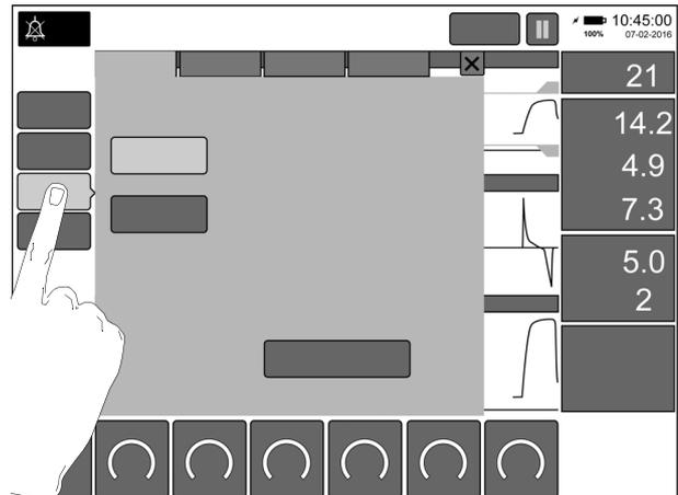
L'utente può scegliere tra la calibrazione del sensore di flusso o il sistema di ossigeno (100%).
