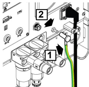
Collegare l'estremità libera del cavo di collegamento equipotenziale dal ventilatore (3) al punto di collegamento equipotenziale (4).
