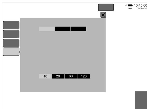
Il pannello "Livello di SpO<sub>2</sub>" consente all'utente di selezionare quale forma d'onda del ventilatore viene mostrata nella parte superiore della schermata e la base di tempo per gli andamenti.
