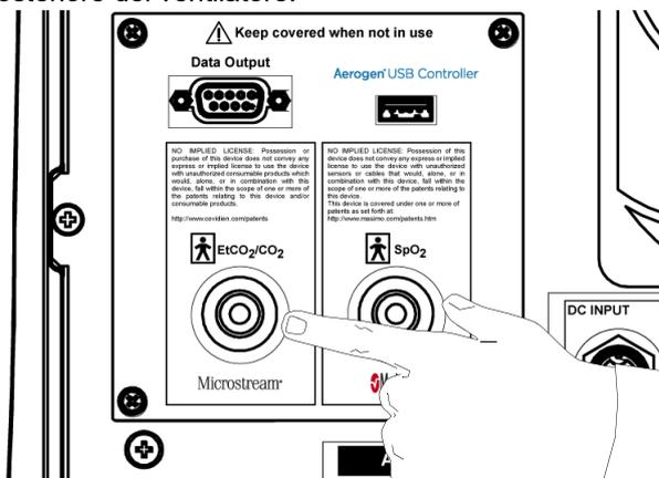
Questo cavo serve per la comunicazione dati e l'alimentazione, con il modulo che riceve la potenza dal monitor attraverso questo collegamento. Non è necessaria una fonte di alimentazione separata.
