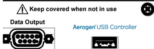
**Nota:** il controller USB Aerogen® può essere azionato solo da una porta USB su qualsiasi dispositivo medico elettrico approvato in base a IEC/EN 60601-1 o adattatore CA/CC del controller USB Aerogen.
