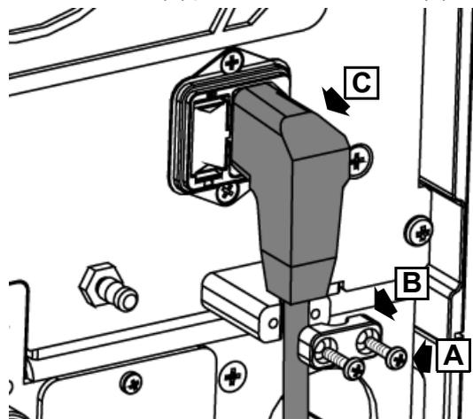
Rimuovere il cavo di alimentazione elettrica di rete (C).
