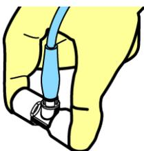
**Attenzione: per evitare la contaminazione del sensore di flusso, utilizzare i guanti quando si effettua la calibrazione.**
